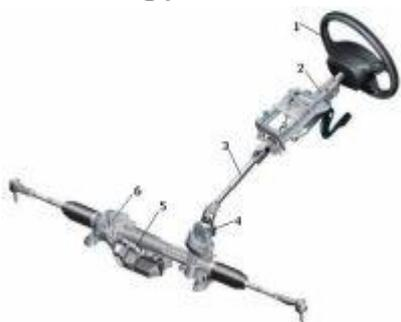
**Рулевое колесо** воспринимает от водителя усилия, необходимые для изменения направления движения, и передает их через рулевую колонку рулевому механизму. Рулевое колесо выполняет также и информационную функцию. По величине усилий, характеру вибраций происходит передача водителю информации о характере движения. Диаметр рулевого колеса легковых автомобилей находится в пределах 380 - 425 мм, грузовых автомобилей – 440 – 550 мм. Рулевое колесо спортивных автомобилей имеет меньший диаметр.
